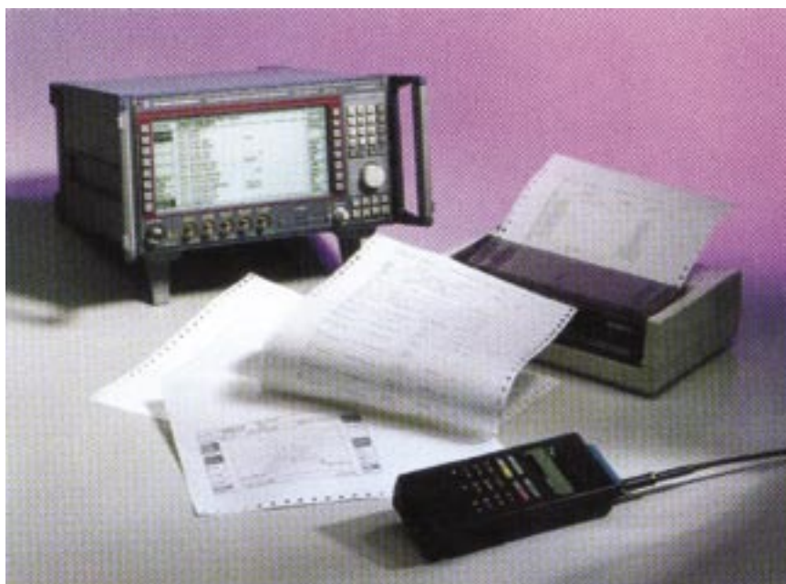
Алгоритмы тестирования, результаты и содержимое карт памяти можно распечатывать на подключенном принтере
